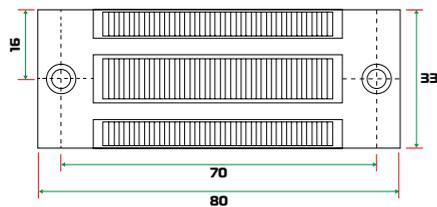
Dimensões barra metálica
