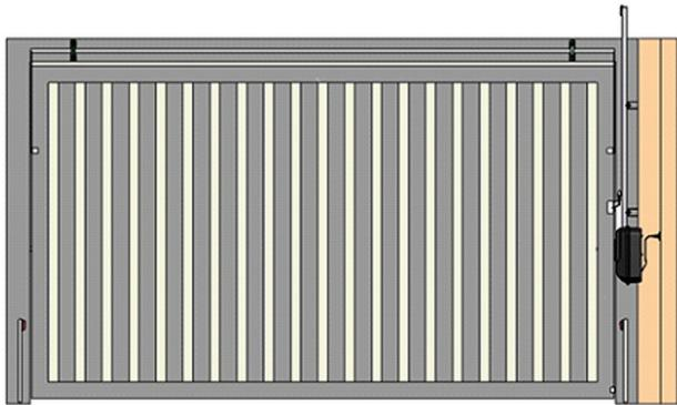
Após todos esses procedimentos trave o pino da porca acionadora ao braço articulado com uma cupilha que virá junto ao Kit de Instalação ou se preferir com um cadeado.
