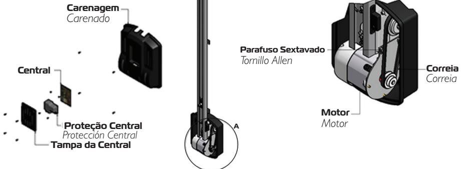
Pressione o motor para baixo esticando a correia. Após ter esticado, monte as proteções do equipamento.
