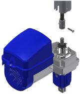
2. Encaixe o trilho a carcaça do motor e parafuse com os 3 parafusos 6x16 presentes no kit de instalação, unindo o acionamento ao motorredutor.
