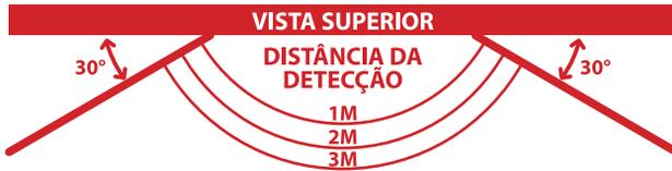
A imagem acima mostra a distância máxima de detecção que é de aproximadamente 3 metros com o sensor instalado a uma altura de 2,20 metros. Ao instalar com uma altura diferente, essa distância pode variar.
