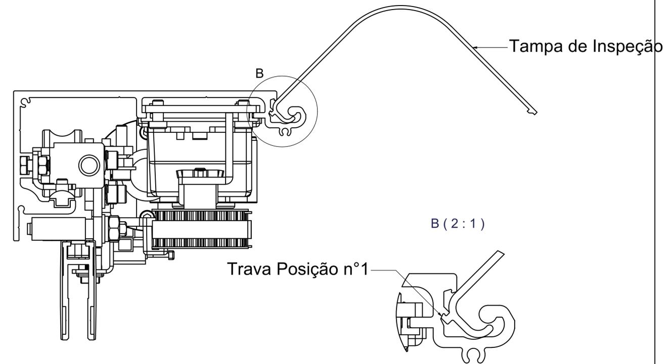
Abaixo figura apresenta esquema referente a posição de estera nível 2. Posição recomendada quando há bloqueio na parte superior do equipamento.
