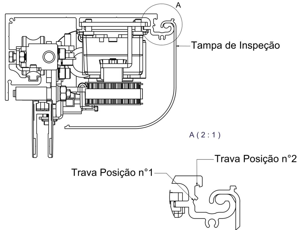
Abaixo figura apresenta esquema referente a posição de estera nível 1. Posição recomendada quando não há bloqueio na parte superior do equipamento.
